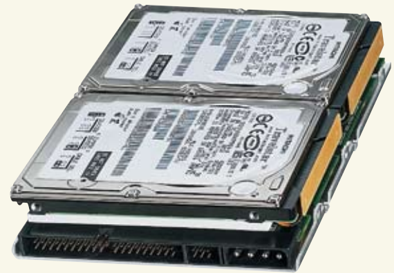
» Adtron I35MB DiskpakT — RAID уровня 1 (Mirroring) из двух дисков с интегрированным контроллером, в форм-факторе 3,5" Single Slot
